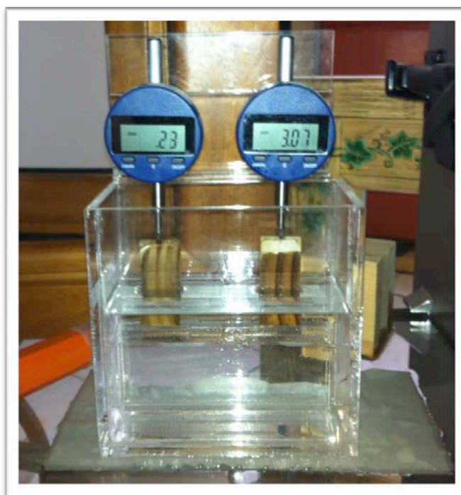
Foto in stabilimento: Da questa foto possiamo notare la dilatazione dei due legnami alla sinistra un accoya alla destra un semplice pino radiata.
